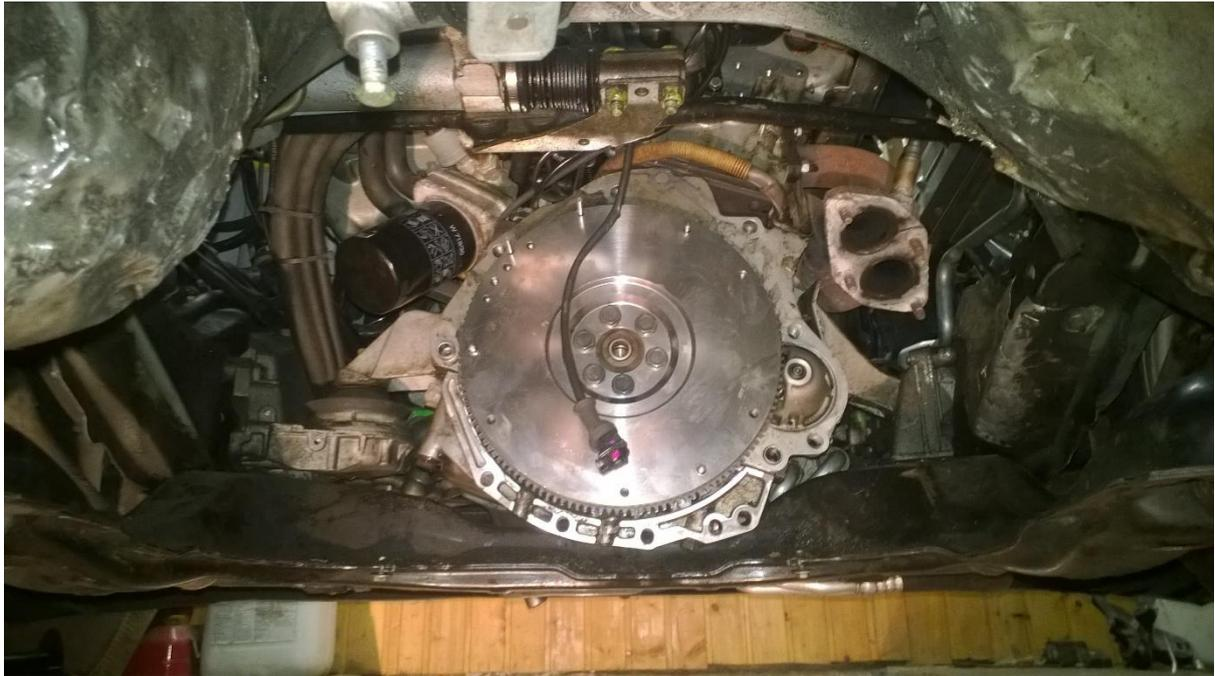
Druckplatte und Kupplung
