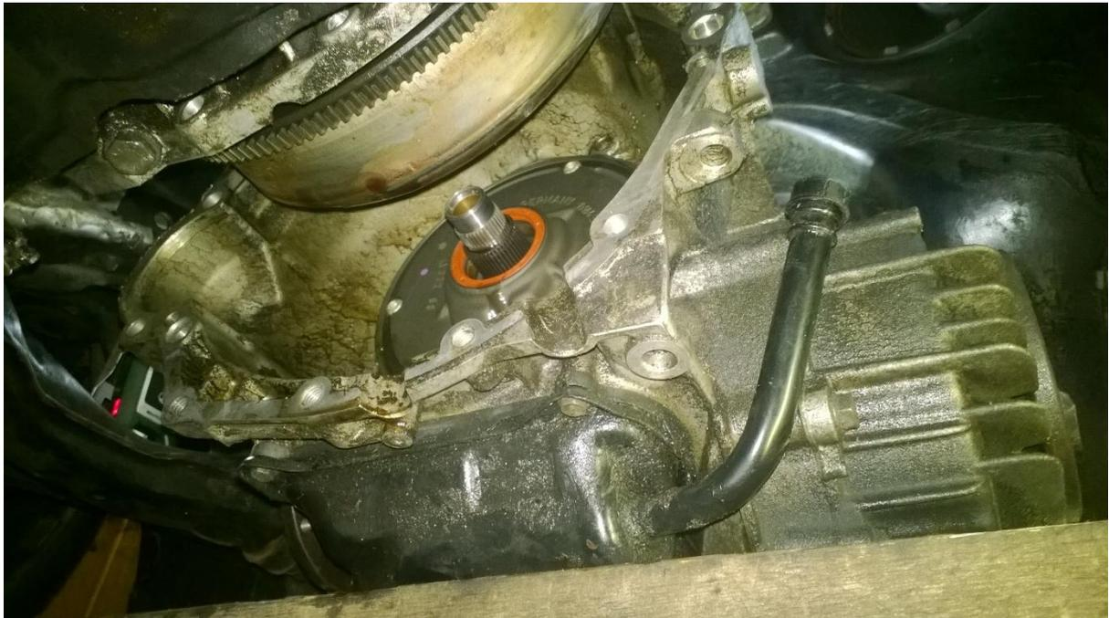
Ich wusste zu dem Zeitpunkt leider nicht dass man auch den Wandler lösen kann, in dem man den Anlasser ausbaut und durch diese Öffnung die Befestigungsschrauben des Wandlers löst. Dann wäre dieser mit dem Getriebe herausgeflutscht und es wäre weniger anstrengend gewesen.
