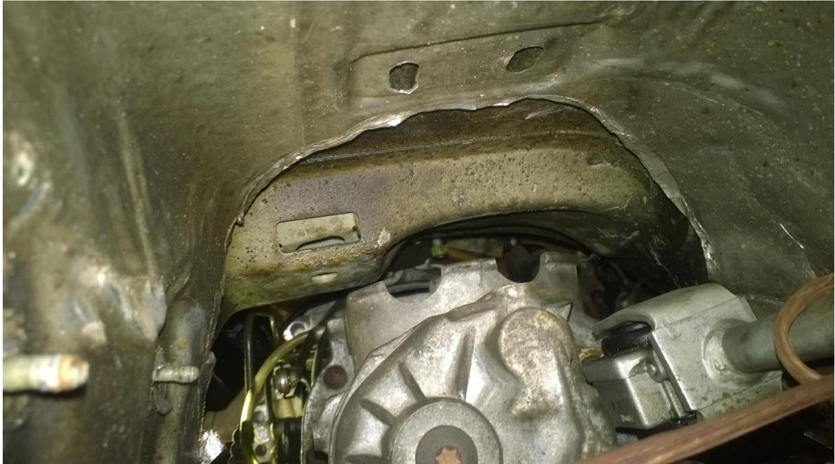
Das Schaltgetriebe wird hingegen auf der Fahrerseite gestützt, von einem Halter den ich erst noch einschweißen musste.
