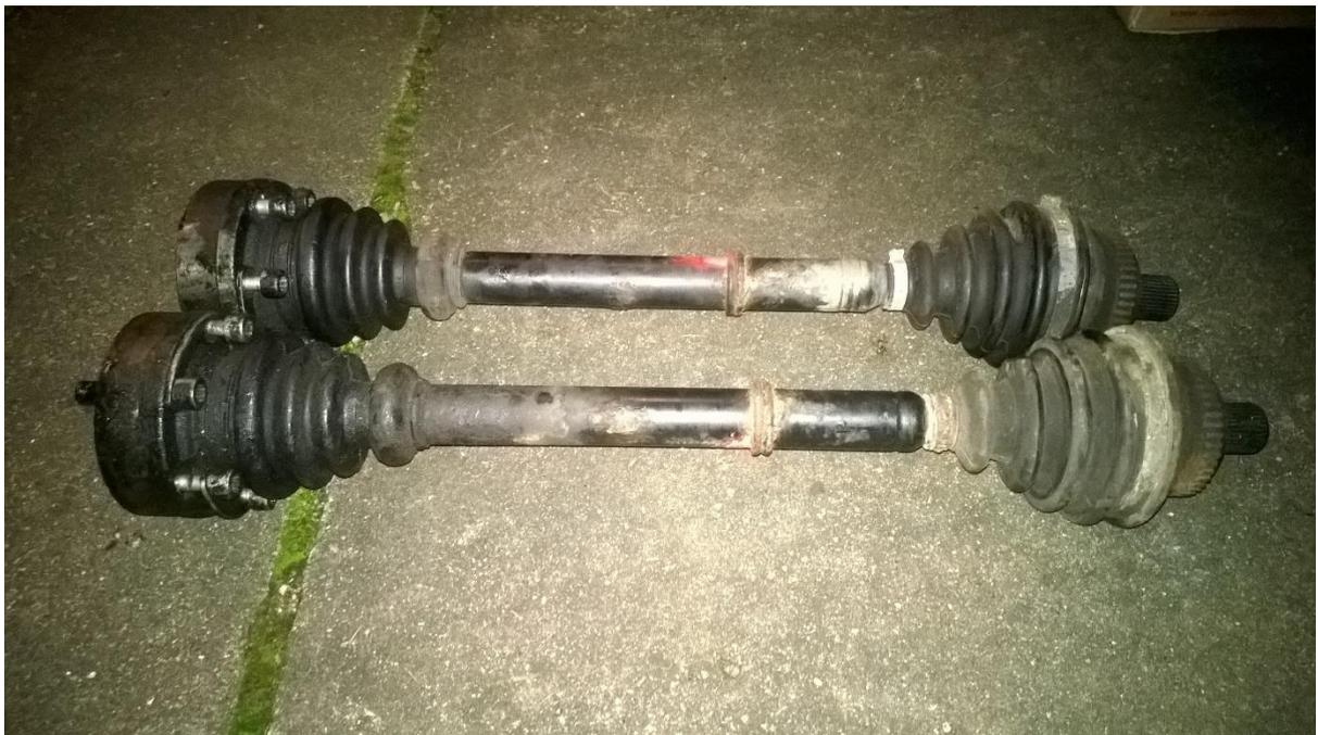
Im Vergleich zu den Automatikwellen, welche dicker und kürzer sind und vor allem andere Flansche (Tripoden) besitzen
